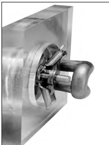
La fixation V-Loc™ s'ouvre vers l'extérieur quand on serre le boulon d'arrêt.
